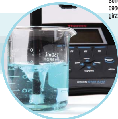
Sonda Agitadora Orion Star en acción – mezclado de muestra sin agitador separado
